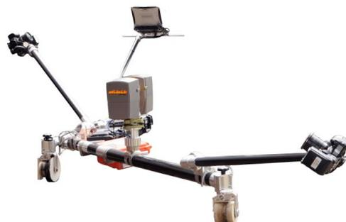
Lo scanner fotografico 3002 (FSC) è stato ottimizzato per i lavori di avanzamento in galleria (ripresa dello scavo grezzo o con sprizbeton), può però anche essere impiegato efficientemente nella ripresa a pieno campo nei lavori di risanamento e ispezioni. Il calcolo dei risultati viene basato sulla fotogrammetria.
