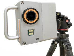
Speziell für Hochgeschwindigkeitsaufnahmen bei vollflächigen Bestandsaufnahmen wurde das fotogrammetrische Messsystem FSC 6100-SRmF10 entwickelt. Während einer kontinuierlichen Bewegung des Aufnahmesystems werden 360° der Tunneloberfläche mittels Hochgeschwindigkeits-Kameras der neuesten Generation aufgenommen. Die Fotos dienen der 3D Rekonstruktion bzw. Texturierung aller Tunnelstrukturen mit bisher unerreichter Geschwindigkeit und Präzision.
